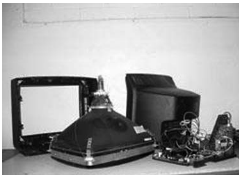
Figura 8: Vista al detalle de componentes de monitores: TRC, plaquetas, carcasas plásticas y cables
