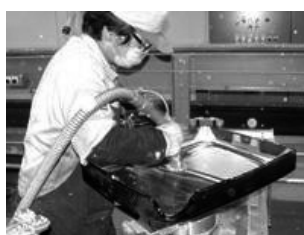
Figura 11a, b: Limpieza del fósforo del frente del monitor, previo a la valorización del vidrio
