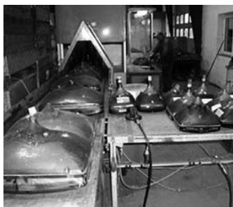
Figura 9: Vista del sistema de corte de TRC propuesto en sistema de vacío para captura
